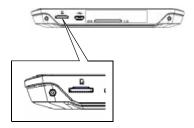
Der Karteneinschub befindet sich im linken Bereich der Geräteunterseite. Das Kartenfach ist mit einem federbetätigten Rast- und Auswurfmechanismus ausgerüstet.
